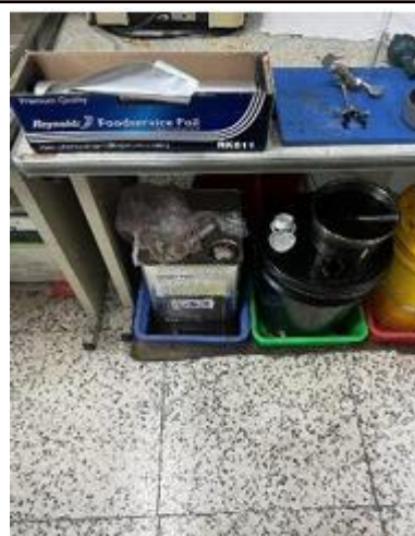
▲防液盤之化學廢液未定期清除
