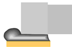
(c) 焊錫浸潤不足
