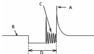
154. (124) 有一天康先生駕駛他的車子到陽明山遊玩，油門猛踩到底爬坡，卻發現引擎無力，且在引擎室聽到異常的敲打金屬聲音，若檢驗當時車上電腦爆震感知器的相關紀錄波形(A=汽缸內壓力，B=過濾後汽缸壓力訊號，
