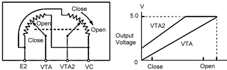
96. (24) 如圖所示為檢測節氣門位置感知器電路時，示波器之輸出電壓曲線如開度電壓圖，對作用與故障原因之判斷，下列敘述何者較正確？ ①VTA2 在開度超過 2/3 時電壓維持穩定 3~5V ②VTA 在開度 1/2 時有斷路現象 ③VTA 在開度 1/2 時有短路現象 ④VTA2 在開度超過 2/3 時電壓維持穩定 5V。
