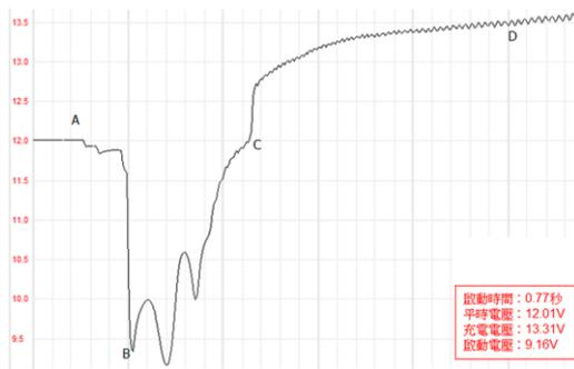
118. (34) 如圖所示起動馬達起動電壓波形分析，橫軸為 0.1s/div、縱軸為電壓值 (V)，解讀波形判斷故障，則下列敘述何者正確？ ①電瓶電量不足必須更換 ②搖轉(Cranking)時間太長 ③C 點為引擎發動點 ④起動後開始充電。
