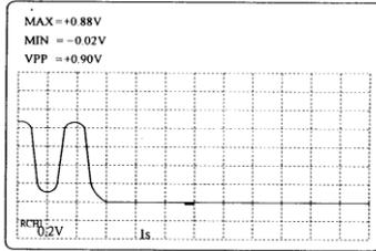
116. (3) 利用示波器量測電位計式節氣門位置感知器得到如圖所示之波形，其意義代表
