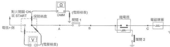
104. (13) 如圖所示當車輛之燈泡燈光黯淡，以電壓錶逐步檢測其電路，檢測結果分別為 12V、11.9V、7.9V、0V，則有關故障之判斷下列何者正確？ ①開關之電壓降為 0.1V 係屬正常 ②開關負載端至燈泡電源端電壓降為 7.9V，有部分斷路現象 ③開關負載端至燈泡電源端電壓降為 4V，有電線阻抗過高情形 ④負載搭鐵端到電瓶負極搭鐵為 0V，表示搭鐵不良。
