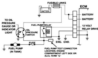
127. (134) 如圖所示，下列敘述何者錯誤？ ①Key On，使用電錶Ω檔由燃油泵測試接頭，可以檢測燃油泵線圈導通性 ②引擎運轉時，使用電壓錶檢測燃油泵測試接頭測得電瓶電壓，確認燃油泵繼電器功能正常 ③引擎運轉時，使用電壓錶檢測燃油泵測試接頭測得電壓值為零，確認燃油泵繼電器故障 ④由燃油泵測試接頭跨接電瓶負極，供電驅動燃油泵。
