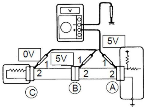
92. (12) 如圖所示以歐姆錶分別測量 A1 至搭鐵、A2 至搭鐵時，其測量結果何者錯誤？ ①A2 至搭鐵間導通 ②A1 至搭鐵間導通 ③A1 至搭鐵間電阻值無限大 ④A2 至搭鐵間電阻值無限大。
