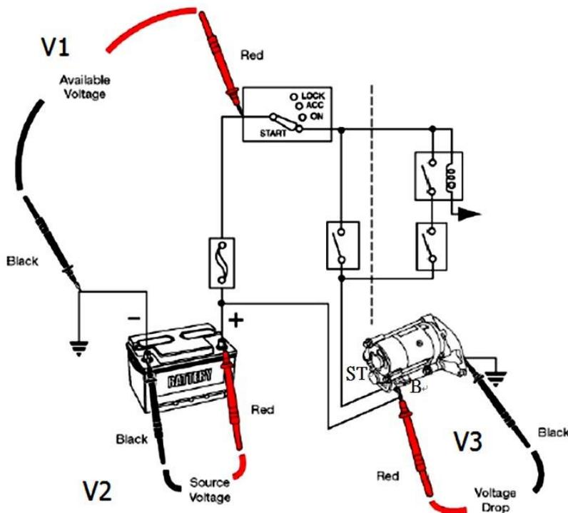
136. (234) 如圖所示為起動電路圖，當檢測時有關  $V1$ 、 $V2$ 、 $V3$  之敘述，下列何者正確？ ① $V1$  為電瓶開路端電壓 ② $V2$  為電瓶起動電壓 ③ $V3$  為起動馬達電壓降 ④正常作用下  $V2 > V1 > V3$ 。
