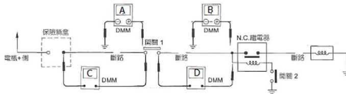
100. (24) 如圖所示利用多功能數位電錶進行線路導通性與電壓檢查，並分別以 A、B、C、D 四種數位電錶測量，下列敘述何者正確？ ①A 為電壓錶可測得 12V ②B 為電壓錶可測得 0V ③C 為電壓錶可測得 12V ④D 為歐姆錶可測得  $\infty \Omega$ 。
