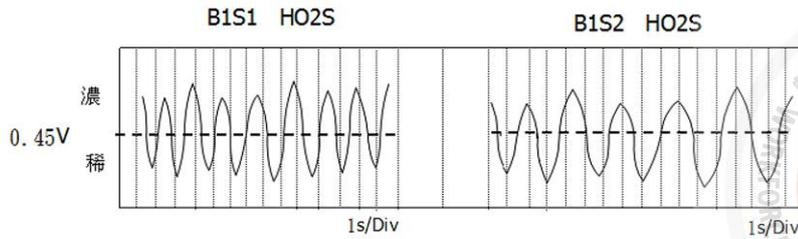
175. (34) 如圖所示為配備第二代隨車診斷系統(OBD II)車輛中，在引擎 2500rpm 所擷取三元觸媒轉換器前、後銻材含氧感知器之波型，下列敘述何者錯誤？ ①前含氧感知器(B1S1)作用正常 ②比較前含氧感知器(B1S1)及後含氧感知器(B1S2)波型可判定觸媒良好 ③依後含氧感知器(B1S2)波型可判定進氣歧管漏氣 ④後含氧感知器(B1S2)不良，因轉換頻率不佳。
