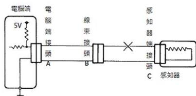
94. (134) 如圖所示某感知器之電路狀況有斷路現象，當進行修護時，下列敘述作法何者錯誤？ ①更換感知器 ②更換接頭 B 到接頭 C 之間線束 ③更換接頭 A 到接頭 B 之間線束 ④更換控制電腦。
