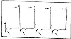
107. (1) 以示波器檢驗引擎時，如每缸跳火電壓相同但太低，其故障可能是 ①混合氣過濃 ②分火頭間隙太大 ③點火時間太早 ④點火線圈主高壓線斷路。
