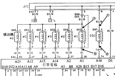
127. (2) 如圖所示係脈波式線性驅動電壓及作動器驅動回路，其中  $V$  為驅動信號電壓，有關作動器驅動電流之敘述，下列何者正確？ ①當作動器阻抗一定時，於停止狀態時驅動電流為最大 ②當作動器阻抗一定時，於驅動信號電壓  $V$  平均電壓變低時驅動電流變大 ③當作動器驅動電壓一定時，於作動器之阻抗變大時驅動電流變大 ④驅動電流隨驅動信號平均電壓  $V$  及
