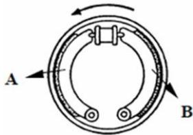
134. (234) 如圖所示配備鼓式煞車來令片之車輛，依箭頭方向行駛，下列敘述何者錯誤？ ①蹄片 A 有自動煞緊作用 ②蹄片 B 磨耗程度較嚴重 ③蹄片 A 側之分泵內徑比蹄片 B 側之分泵內徑大 ④蹄片 B 比蹄片 A 的自動煞緊作用力大。
