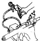
63. (3) 如圖所示中對轉向軸，是實施下列何項操作？ ①檢查煞車鼓間隙 ②檢查煞車蹄片間隙 ③檢查軸承軸向間隙 ④檢查轉向軸軸向間隙。
