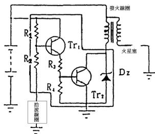
111. (2) 如圖所示為點火系統何種訊號發生器的輸出波型？ ①Pickup Coil Type ②Hall-Effect Type ③Magnetic Pulse Type ④Braker Type Generator。
