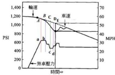
輪速、車速與煞車壓力變化之關係
