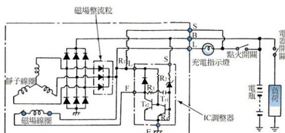
12. (2) 如圖所示之充電波型是何種現象 ①整流粒斷路 ②整流粒短路 ③磁場線圈短路 ④靜子線圈斷路。
