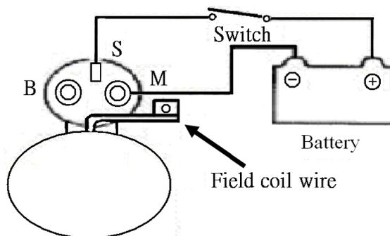
65. (3) 測試起動馬達如圖所示，用手將起動馬達小齒輪推出小齒輪止擋片的位置，如果小齒輪保持推出的位置，則表示下列何者作動正常 ①起動馬達電樞 ②電磁開關吸入線圈 ③電磁開關吸住線圈 ④電磁開關接點。
