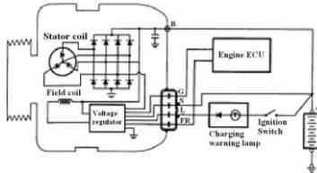
68. (4) 如圖所示，當引擎發動、充電系統作動正常、當電流錶測得 10A 電流值時，則電壓錶之測量值較可能為 ①12V ②6V ③ $\infty$  ④0.5V。
