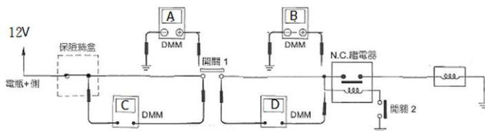
102. (123) 如圖所示利用多功能數位電錶進行線路檢查，其結果下列敘述何者正確？ ①開關之電壓值為 0.1V，是開關之電壓降，仍屬正常值 ②電瓶到開關之間導線導通正常 ③燈泡與開關之間之阻抗過高，所以有電壓降
