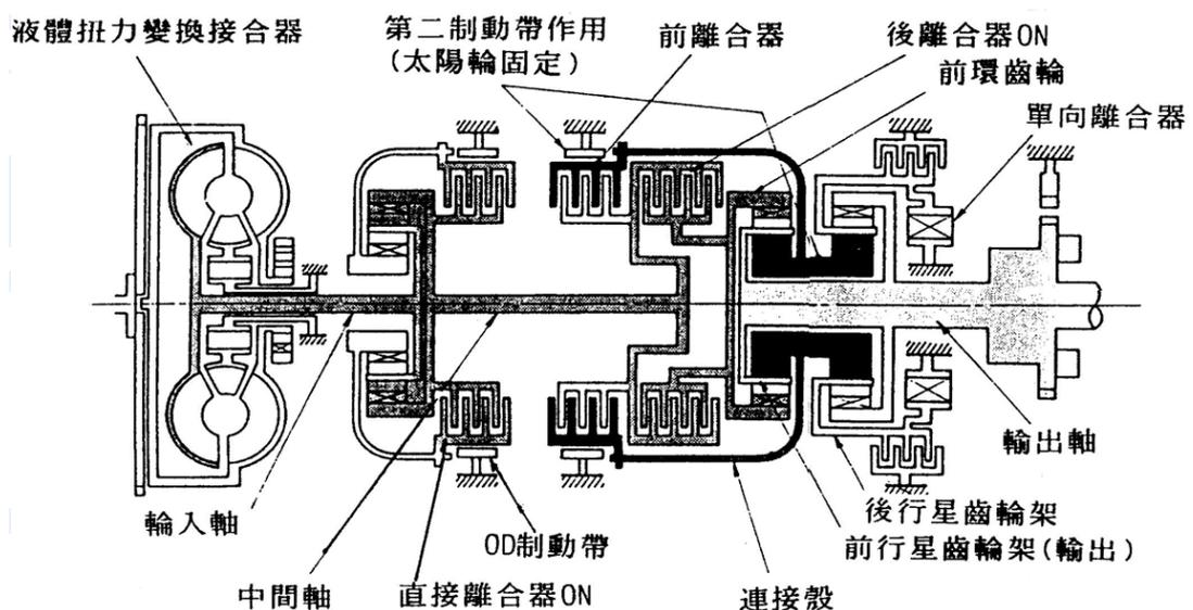
74. (4) 如圖所示為 3 前進檔 AT，若(10)與(17)離合器作動，則輸出軸在在下列何種狀態？ ①前進超速傳動 ②前進減速 ③前進直接傳動 ④倒車。
