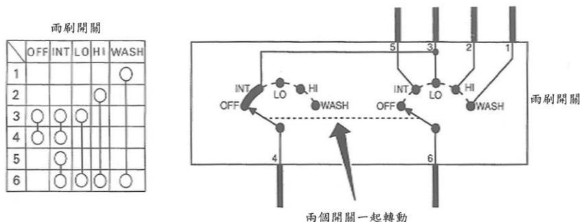
98. (24) 如圖所示為搭鐵控制式之雨刷線路開關表與開關圖，有關開關各段導通性之作用，下列敘述何者正確？ ①在各段作用時第 6 腳為共同電源 ②在 INT 時 3-4，5-6 導通且以第 4，6 為搭鐵 ③1-6 接腳在 WASH 時不導通
