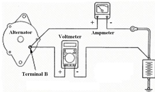
69. (3) 如圖所示，當引擎發動若電流錶測得 0A 電流值，電壓錶測量值為 2V 較可能是 ①發電機損壞 ②電瓶損壞 ③電瓶正極線老化 ④電壓錶損壞。
