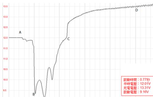
119. (234) 如圖所示為起動馬達起動電壓波形變化，橫軸為 0.1s/div、縱軸為電壓值 (V)，下列敘述何者正確？ ①起動時間約為 0.75s ②起動電壓值約為
