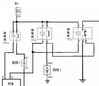
125. (24) 如圖所示某一車輛 TPS 線路，下列敘述何者正確？ ①當 TPS 接頭斷路時，故障項目會顯示 Throttle Position Sensor Circuit Voltage Low” ②如拆開 TPS 接頭測量 PCM 端 3 號腳約為 5V ③如車輛正常狀態下電錶測得的訊號電壓為 0~5 V ④PCM 3 號腳內部之 5V 電壓為提供自診使用。
