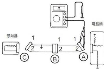
93. (123) 如圖所示某感知器之電路狀況有斷路現象，下列敘述何者正確？ ①電腦無法接收感知器正確作動訊號 ②電腦接收迴路訊號電壓值為 5V ③拆除線束接頭 B，以電壓錶測量 B 接頭電腦側兩端子間電壓約為 5V ④拆開感知器端接頭 C，以歐姆錶測量感知器側接頭二端子間，電阻值為無限大。
