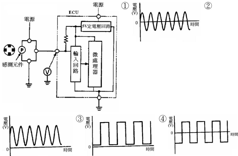
167. (124) 如圖所示係因為電子控制式自動變速箱故障警告燈亮起，確認其故障碼結果顯示為「節氣門位置感測器(TPS)系統」相關故障；因此於節氣門開度開啟 1/2 時進行如圖所示中 V 位置電壓量測，電壓量測結果為 0V，有關其故障原因之敘述，下列何者錯誤？ ①ECU 內信號回路斷路 ②感測
