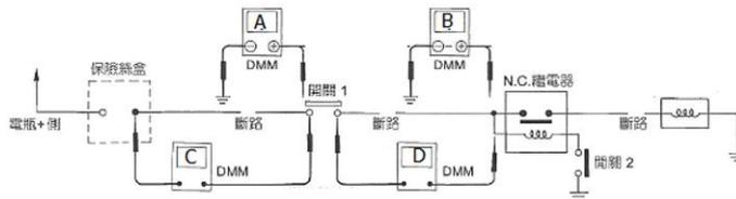
101. (134) 如圖所示利用多功能數位電錶進行線路檢查，並分別以 A、B、C、D 四種數位電錶測量，下列敘述何者錯誤？ ①A 為電壓錶測得 12V 表示保險絲盒到開關 1 之間斷路 ②B 為電壓錶測得 12V 時表示開關 1 按下時能導通 ③C 為歐姆錶測得  $\infty \Omega$ ，表示保險絲盒到開關 1 之間斷路 ④D 為歐姆錶可測得  $\infty \Omega$ ，表示開關 1 到繼電器間線路無斷路。
