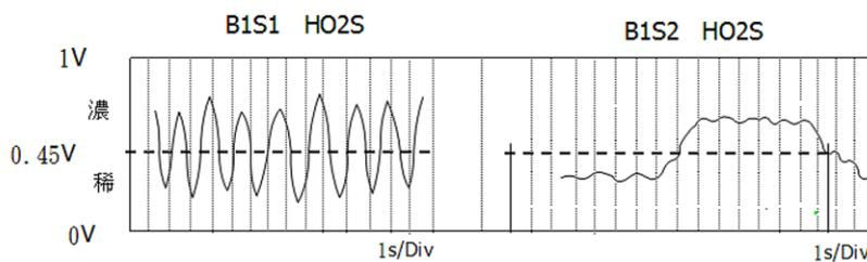
176. (34) 如圖所示新式車輛配備有第二代隨車診斷系統(OBD II)，系統中裝設有空燃比(A/F)感知器及後含氧(H2OS)感知器，兩者混合比與電壓、電流變化曲線如圖 a、b，則下列敘述何者正確？ ①圖 a 為含氧感知器曲線，當混合比稀時電壓高，混合比濃時電壓低 ②圖 b 為空燃比(A/F)感知器曲線，當混合比由稀到濃時電流由低變高 ③空燃比(A/F)感知器在閉迴路控制狀態時，感測混合比範圍較寬也較精確 ④含氧感知器在閉迴路控制狀態，控制混合比到化學當量(stoichiometric)  $\lambda$  為 1 時的感測範圍而言，可控制範圍較窄。
