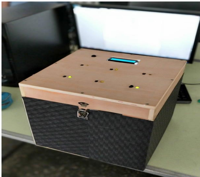
圖 12. 連接行動電源，接上 LED 開始遊戲，完成專題。
