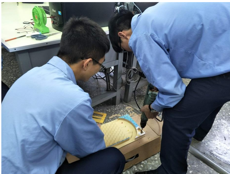
圖(6)七段顯示器安裝鑽孔圖
