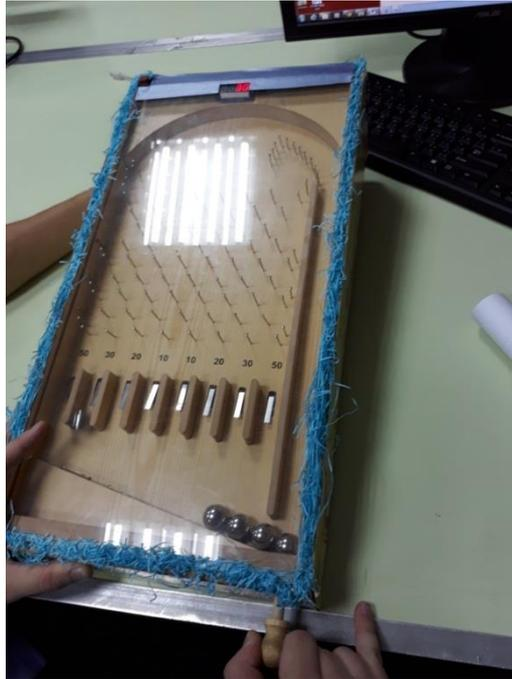
圖(12)彈珠檯彈珠滾到微動開關時觸發七段顯示器計分動作圖
