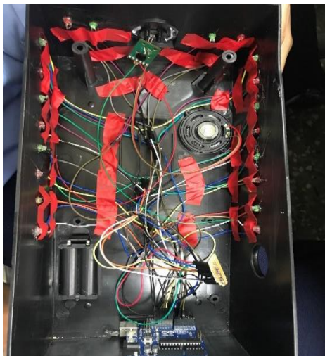
圖(十六)將全部 LED 正負分開相接
