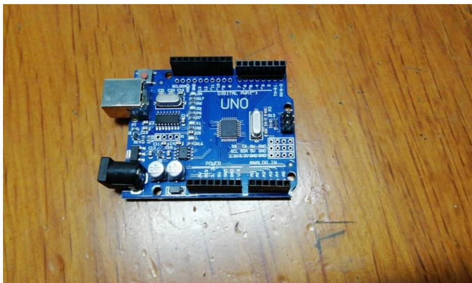
圖(二) Arduino UNO 板
