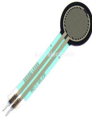
圖(4) 壓力感測器
