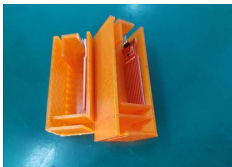
圖 3-3：3D 列印機所製作的水位感知器外殼 (資料來源：研究者自行拍攝)
