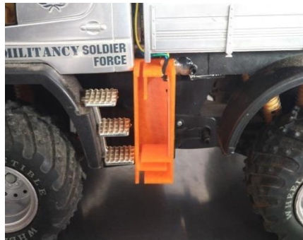
圖 4-6 左側的水位感知器
