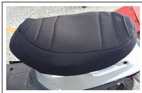
圖 5-5：當座墊隔熱套裝於座墊上
