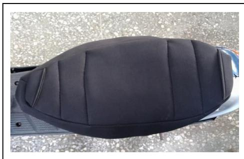
圖 5-4：當座墊隔熱套裝於座墊上
