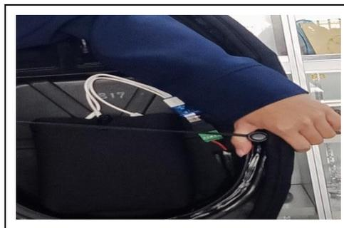
圖 5-13：裝回座墊上並拉緊束帶
