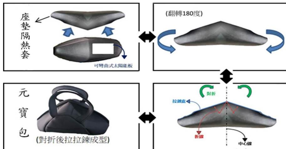
圖 2-1：座墊隔熱套(元寶包)的流程設計圖
