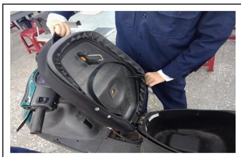
圖 5-6：取下座墊隔熱套
