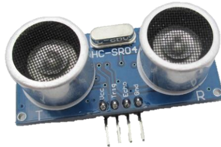
圖 3-5：超音波感知器
