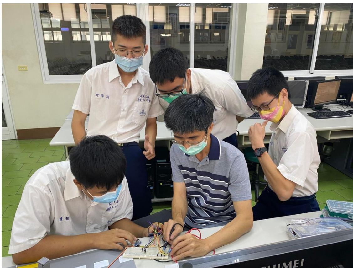
圖 2-1-1 麵包板電路三用電表測試
