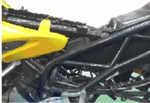
9. (1) 如下圖所示，機器腳踏車主配線上的束帶，必須確實固定於車架上，且須使線束接觸束帶絕緣面，其 A 技師與 B 技師之固定方式何者正確？ ①A 對 B 錯 ②A 錯 B 對 ③A 與 B 都錯 ④A 與 B 都對。
