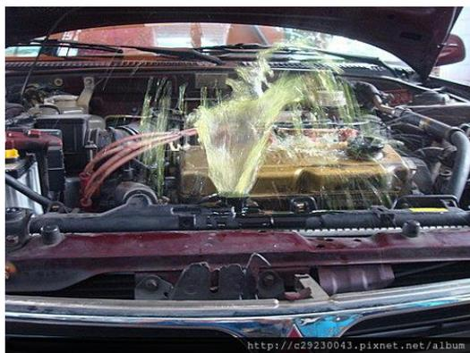
圖 2-1 溫度偏高~水箱蓋壞掉. 致水箱變形或破裂
