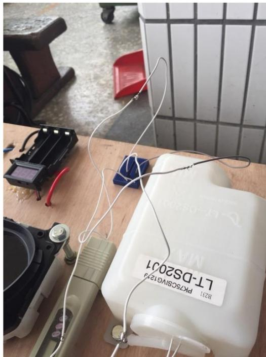
圖 3-2 TDS 檢測筆焊接電線連接到水箱(自製專題內容)
