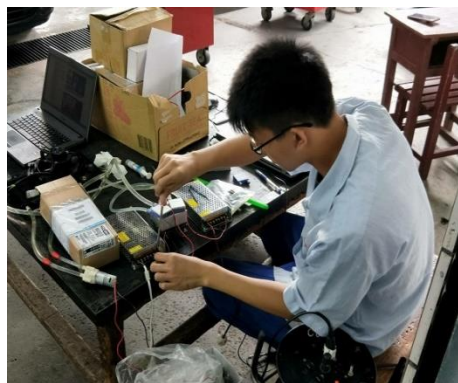
圖 4- 10 致冷晶片電源接上。
