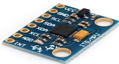
圖 4-8 三軸加速計陀螺儀模組
