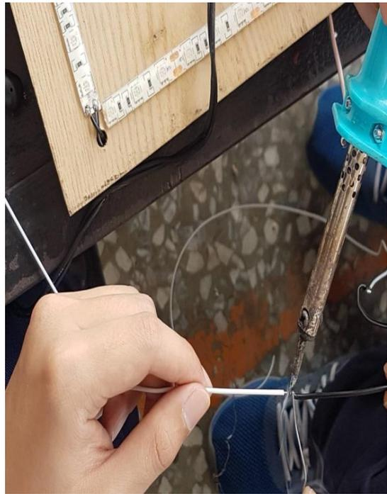
6. 焊接電線，連接線路。
