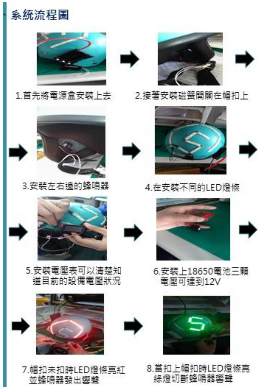
圖 6-1 機車安全帽帽扣警示系統製作流程圖
