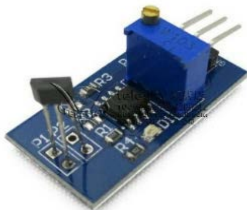
圖 3-7：霍爾測速感測器 (資料來源：2017 年 9 月 21 日，取自 https://goo.gl/sM2qoT )
