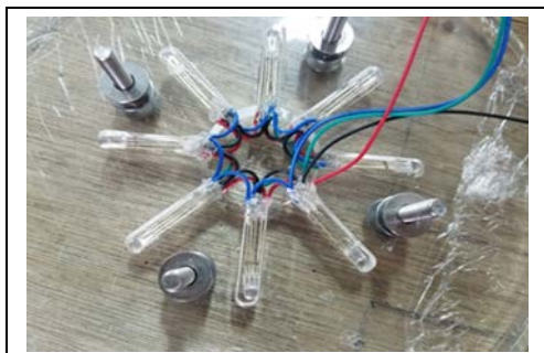
圖 6-9 將三色 LED 連線裝入碟盤
