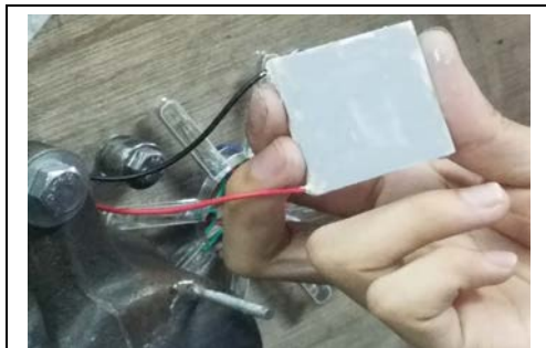
圖 6-3 透過散熱膏裝上致冷晶片
