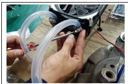
圖 6-7 連接水冷系統各部件水管
