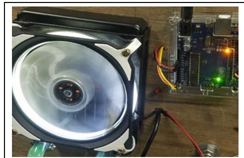
圖 5-8 致冷晶片與風扇強制散熱
