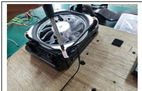
圖 6-5 安裝散熱風扇與水箱
