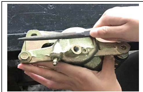
圖 6-1 將煞車分泵部分外殼磨平
