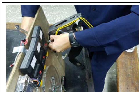
圖 6-12 安裝煞車踏板
