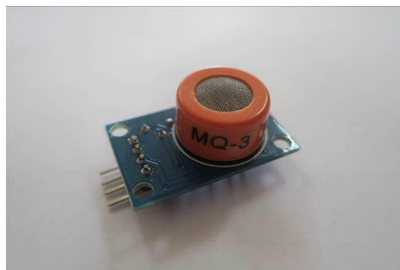
圖 3-1MQ-3 酒精感測器 (取自本研究之材料)
