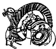
248. (2) 如圖示之操作簡圖，是實施差速器何項操作？①檢查差速器軸承之邊間隙②檢查盆形齒輪之偏移③檢查盆形齒輪與角尺齒輪之齒隙④檢查角尺齒輪與盆形齒輪之後觸面高度。
