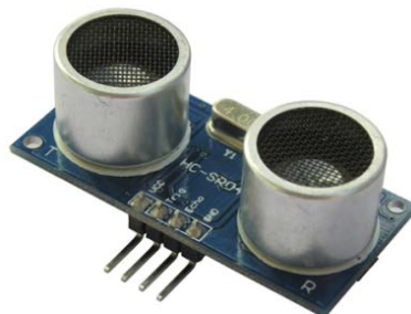
圖 3-3 HC-SR04 超音波感測器，2017 年 1 月 2 號取自 http://coopermaa2nd.blogspot.tw/2012/09/hc-sr04.html
