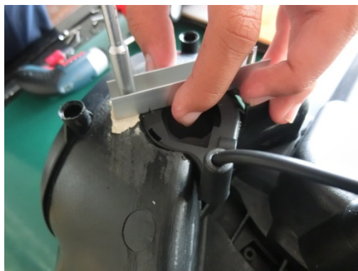
圖 4-8 安裝轉向角度感知器
