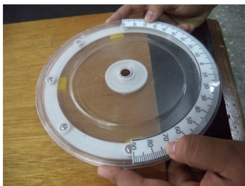
圖 4-10 安裝轉角度顯示盤
