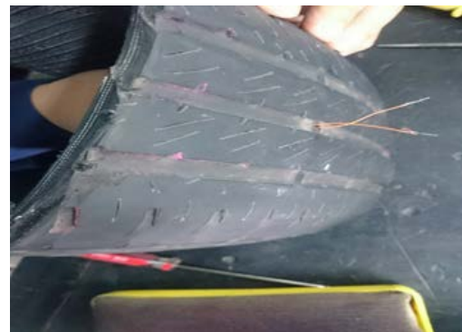
圖 6-2 RFID 天線牽出磨損記號外緣
