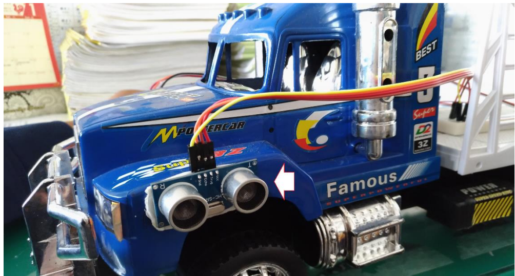
圖 2-9 HC-SR04 超音波感知器
