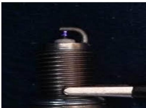
測試火星塞跳火情形，若是正常跳火，則裝置於排氣管側。
