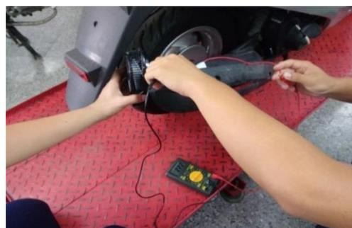
圖 3-4 溫差發電片裝置量測
