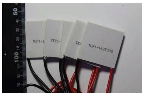
圖 3-3 發電片 TEP1-142T300 型號
