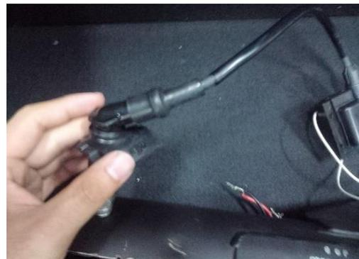
將獨立式高壓線圈接上火星塞，測試是否能獨立跳火。
