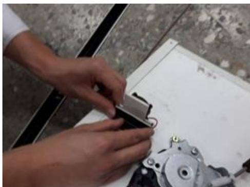
圖 4-3 固定溫差發電片
