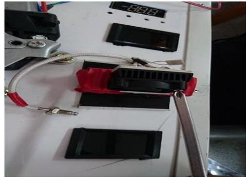
圖 4-6 安裝散熱風扇
