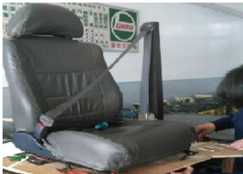
圖 3-5 繫上安全帶進行測試 資料來源：自行拍攝
