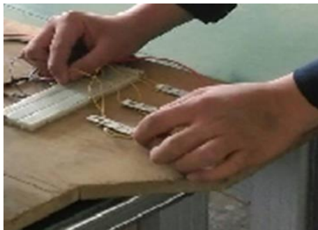
圖 3-3 把微動開關與座椅感知器連結 到 LED 燈條進行測試 資料來源：自行拍攝
