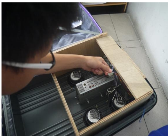
圖八 安裝喇叭和線路 資料來源(自行拍攝)
