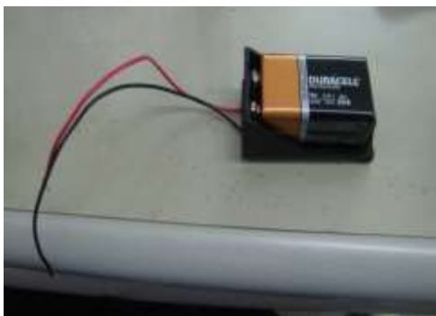
圖(11) 9V 電池與 9V 電池座*2
