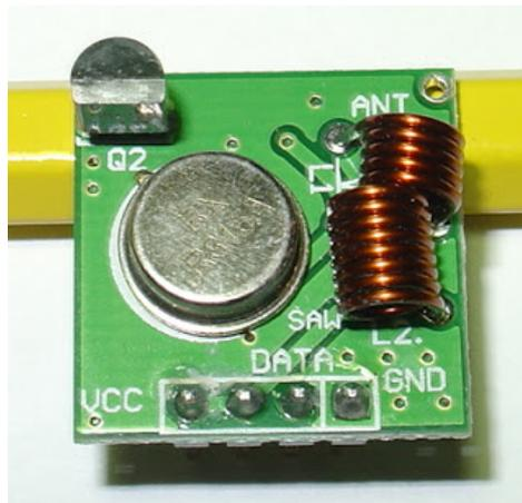
左而右的四支接腳分別接 Vcc (pin-1)、Data-Out (pin-2, pin-3)、GND (pin-4)，其中比較重要的是 Data
