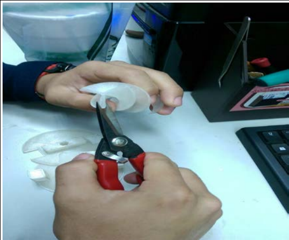
圖 10 修剪列印物件的多餘部分
