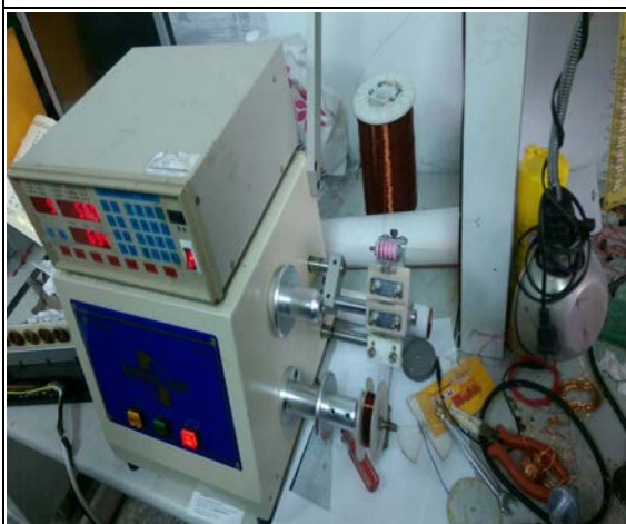
圖 13 將物件繞上銅線並測試功能
