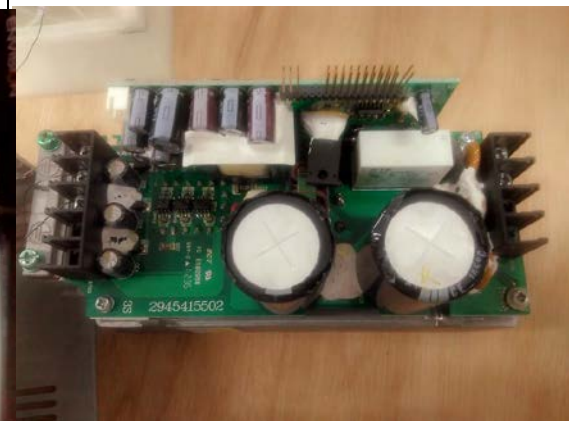
圖 23 變頻器內部電路板
