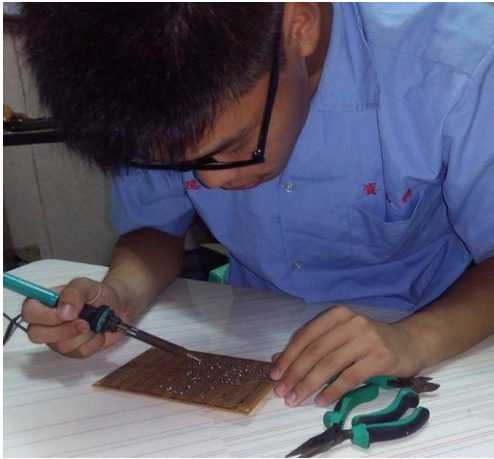
圖 4-1-1 電路板焊接過程
