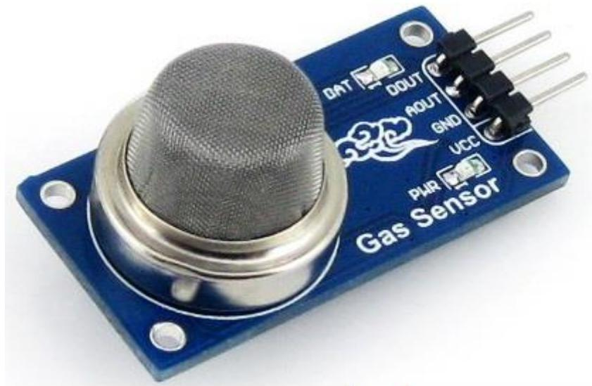
圖 2-1-2 MQ5 氣體傳感器
