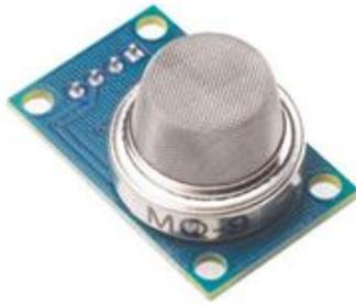
圖 2-1-4 MQ-9 氣體傳感器
