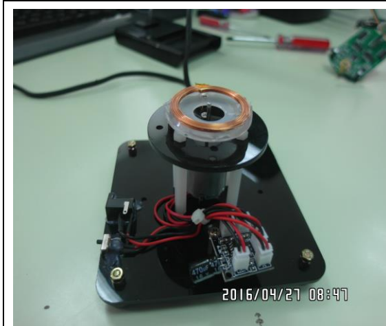
圖 3-3-4 旋轉主板焊接
