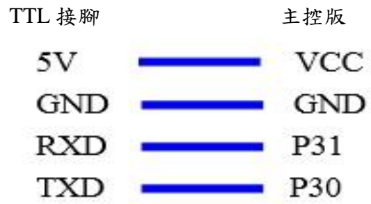
圖4-5TTL與主控版接法
