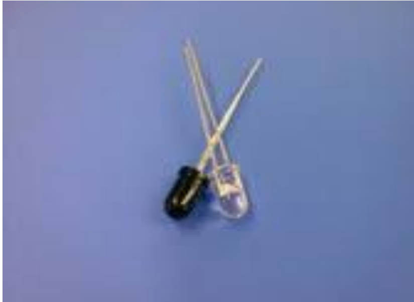
圖 2-4-1 3mm 紅外線發射管
