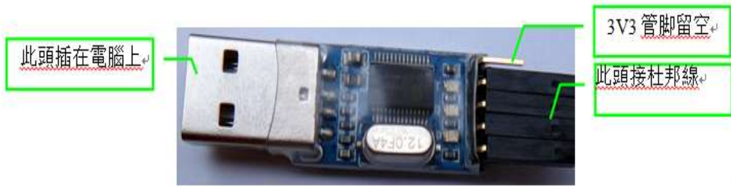
圖 4-1-12 USB 轉串口連接位置
