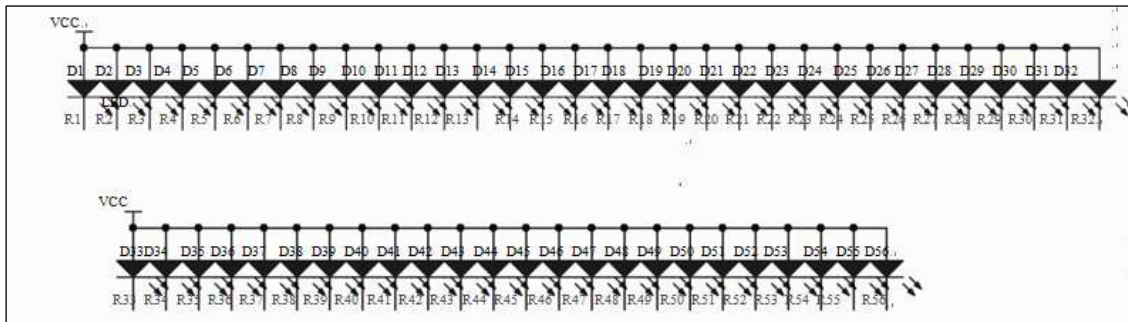
圖 3-3-3 0805 單色 LED 電路
