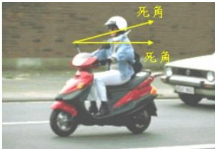
圖6機車後照鏡的死角
