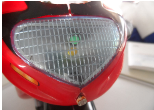
圖 10 偵測到光源頭燈自動熄滅
