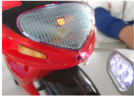
圖 9 偵測到光源遠燈自動切換近燈
