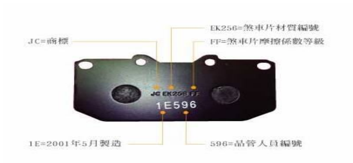
圖 7 汽機煞車片製造出廠標示
