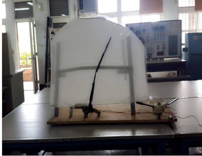
圖 16 雨刷頂高器試教板
