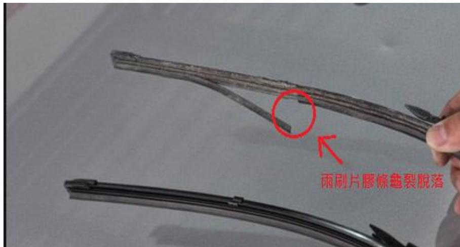
圖4 汽車雨刷破損
