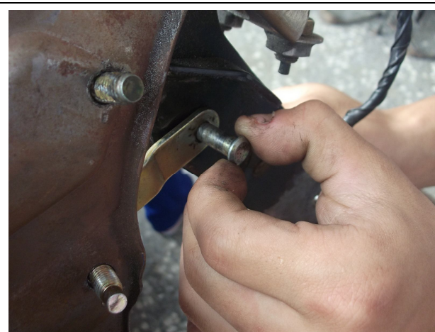
圖19 將倍力氣推桿及踏板插銷裝回
