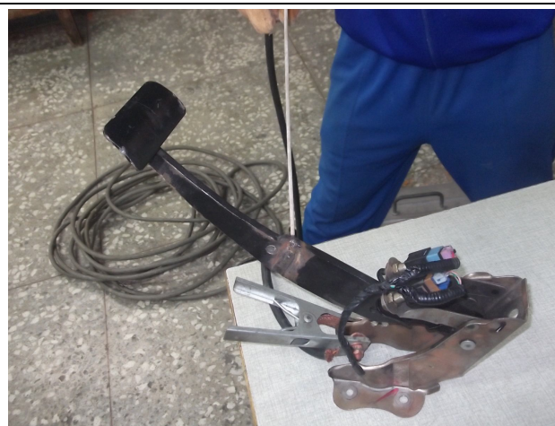
圖12 焊接踏板彎曲截斷部位焊接
