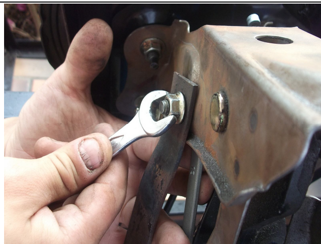
圖21 將腳踏式手煞車及煞車踏板固定 並鎖上
