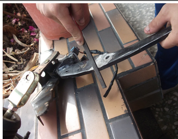
圖16 將磨平部分拋光完成
