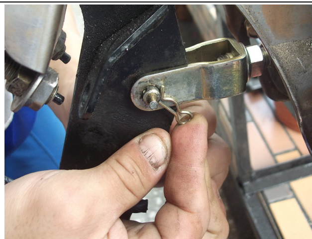
圖20 插入插銷後將固定銷插回
