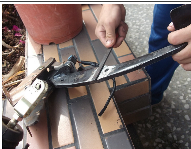
圖15 將磨平後部位用銼刀拋光
