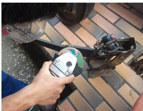
圖13 將焊接部位磨平
