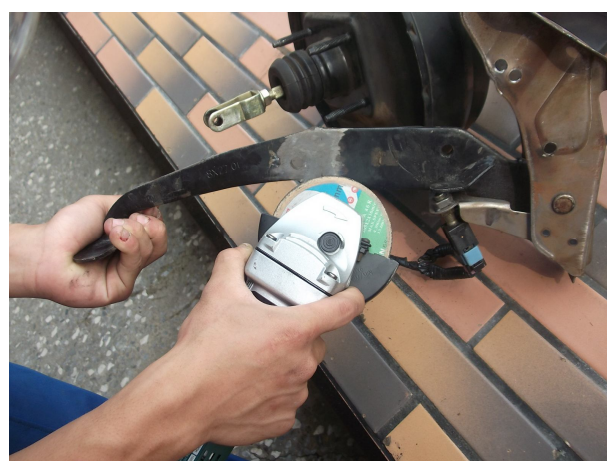
圖14 將焊接部位磨平後
