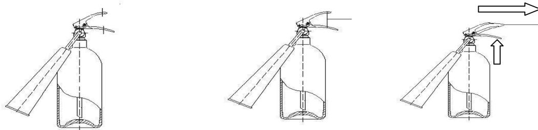
(1) 把滅火器固定引擎室內 (2) 將鋼線穿入把手 (3) 拉動鋼線使其作動
