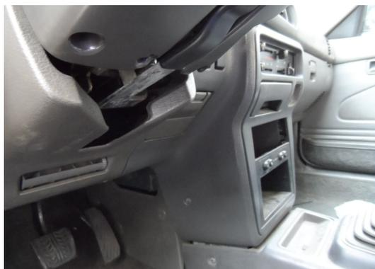
(圖13) 架設滅火器鋼索到車內拉柄
