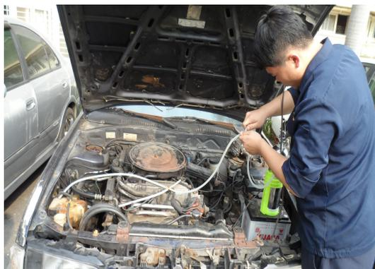
(圖16) 將管線長結合滅火器並牽管
