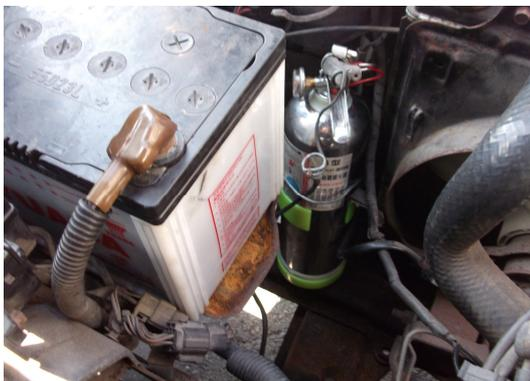
(圖11) 架設滅火器
