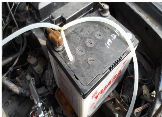
(圖18) 將管線導引至各起火點(二)
