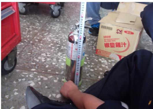
(圖10) 量測滅火器尺寸與空間的搭配
