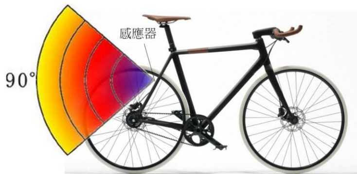
(圖二) 倒車雷達有效感應距離 (資料來源：自行製作 )
