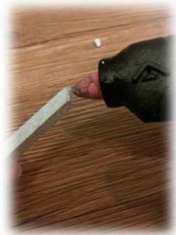
圖 10 把膠擠在飛機木角上
