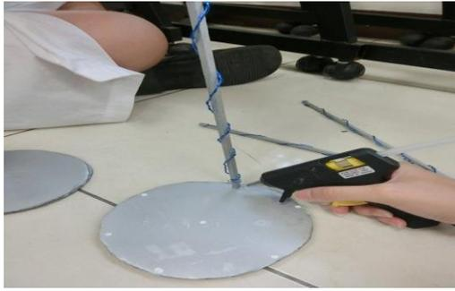
(圖 5)將木棍以熱溶槍固定在紙版上
