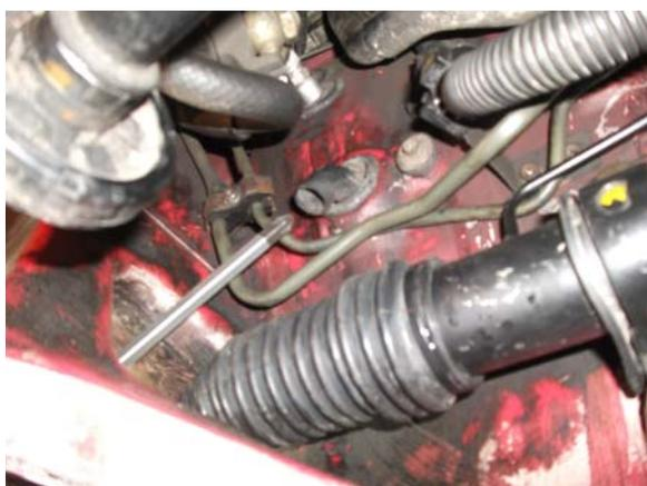
(三) 找出冷氣蒸發機排放廢水的排水口
