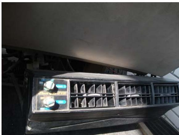
(一) 汽車的冷氣蒸發器車內示意：
