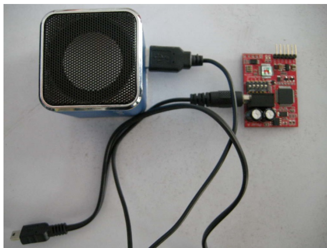
圖23連接喇叭後測試撥放模組是否正常運作
