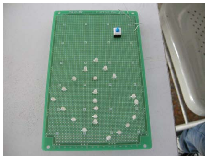
圖21焊接LED警示圖形
