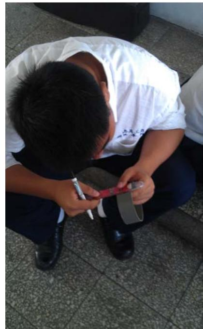
圖 3 PVC 管鑽孔
