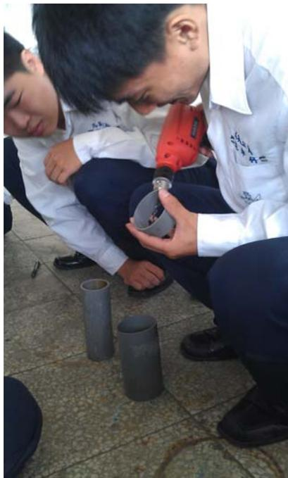
圖 2 PVC 管鑽孔
