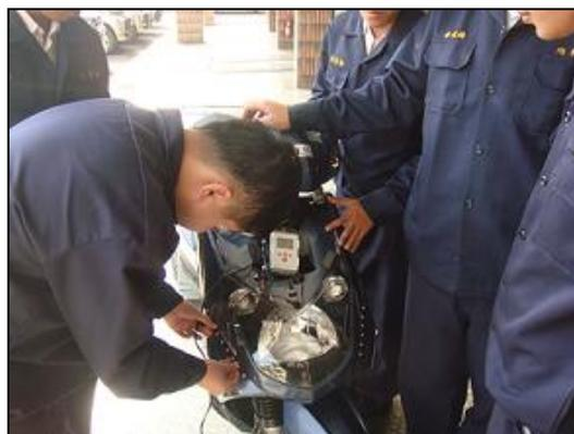
圖 24. 裝置機車智慧型尋車及警示系統線組於機車上
