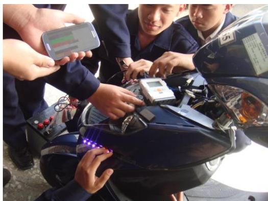
圖 27. 測試機車智慧型尋車及警示系統
